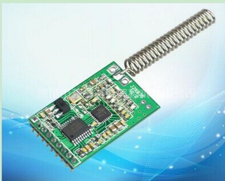
**单表采集器：**安装在配电箱里面，主要负责监控各表的工作状态以及电表用电量的采集，并与上位机中心进行通信。
