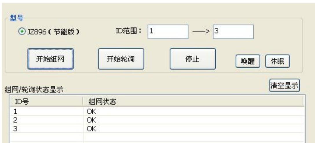
**3.4.3.1 路径重组** 由于其他原因导致个别节点第一次组网无法成功入网时，可以左键单击组网状态显示栏上的 ID 号，使其重新组网。这种单个 ID 点选重新组网功能，有效避免了整个网络的重组，更人性化的入网操作功能让其节点的维护更方便。
