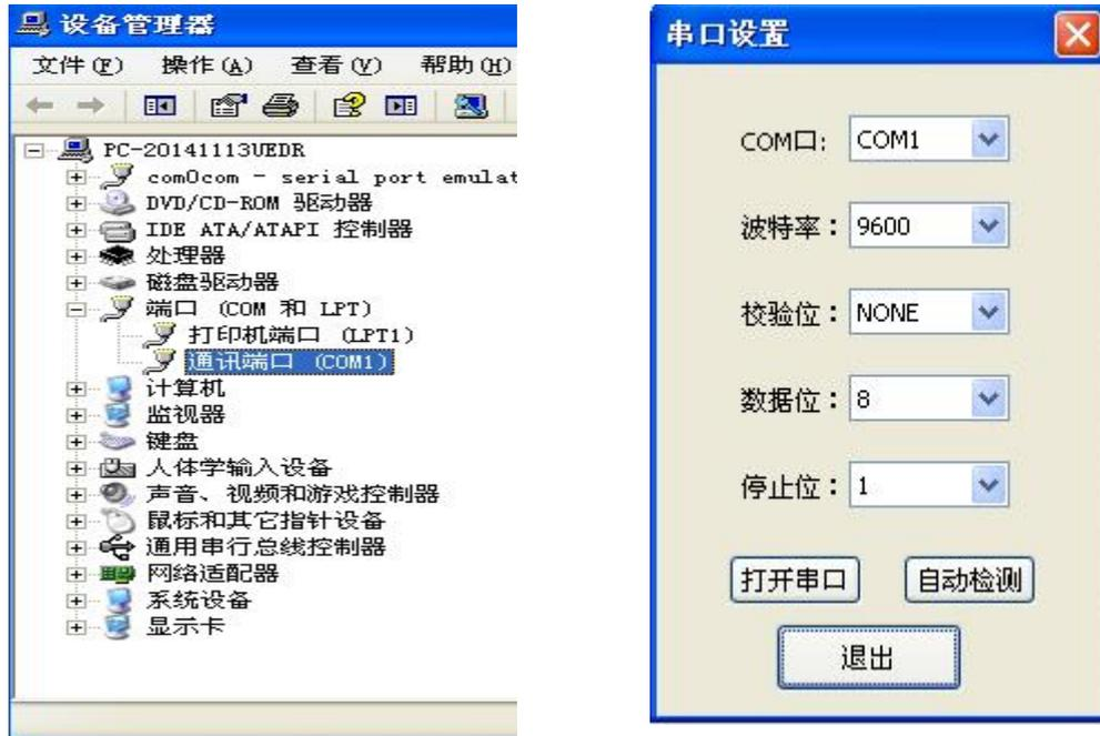
**3.3.3 模块检测** 成功打开串口后，选择“模块检测”，软件运行检测功能，依次采用不同的波特率及校验来检测电台，检测成功后，界面会弹出对话框提示检测成功以及串口参数信息。软件底部状态栏提示检测成功和模块基频。如下图：
