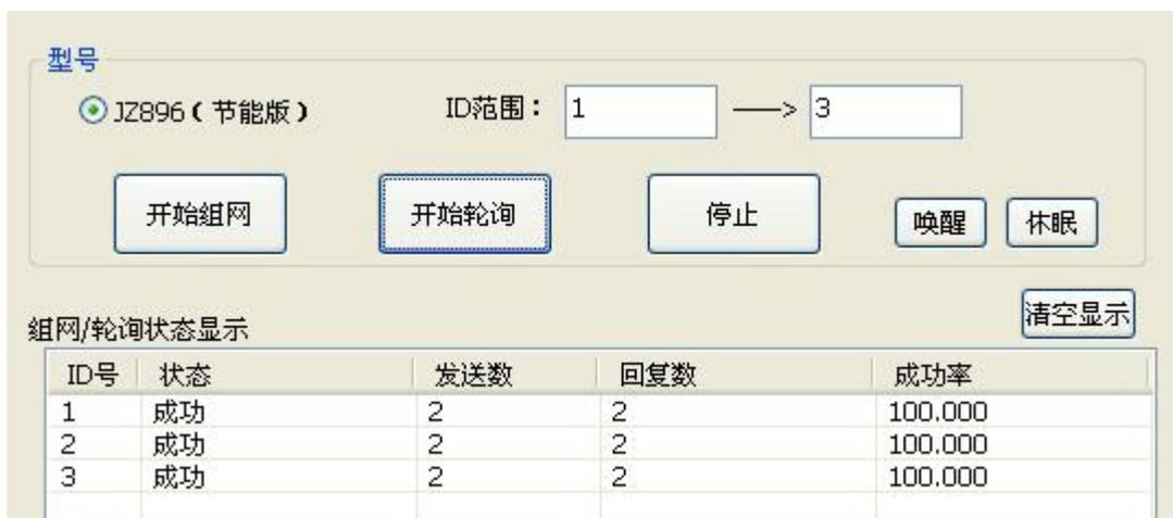
**3.4.5 停止:** 点击可以有效停止“开始组网”或者“开始轮询”功能的操作。
