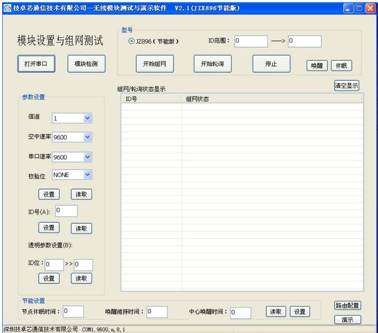
软件界面由操作主面板以及状态栏组成。一些具体的操作可在操作面板通过具体的按钮实现，状态栏用于提示一些具体的操作结果。
