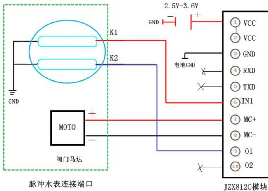
2、JZX812C 表模块与水、气表光电采集模块连接线路图：
