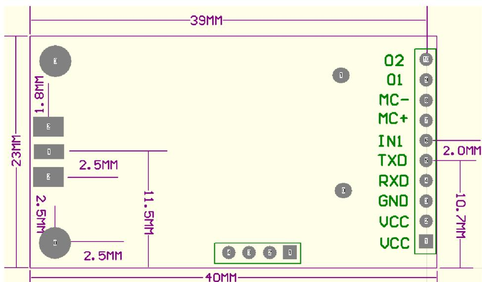
JZX812C 水气表模块提供一个 10 针的连接端口，其具体定义及与终端的连接方法如下表：
