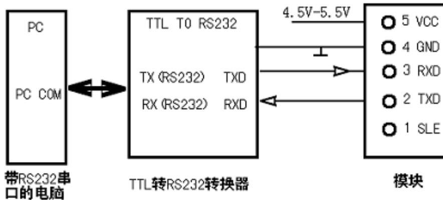
注意：在订购的 JZX814 模块为 TTL 接口方式时，在与 PC 连接时必须加 TTL 转 RS232 的转换器，并且转换器必须供电。
