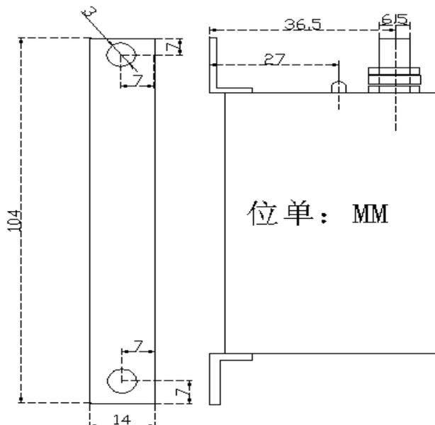
安装时可以用模块所配的二个安装支架来进行安装。
