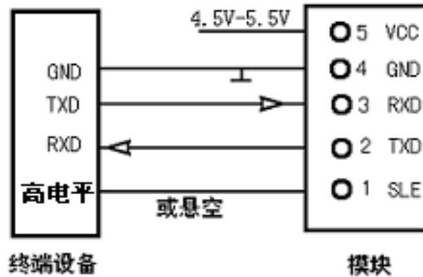
注意：模块的 SLE 脚为高电平时，模块处于休眠状态。SLE 脚是低电平，模块处于正常工作状态。
