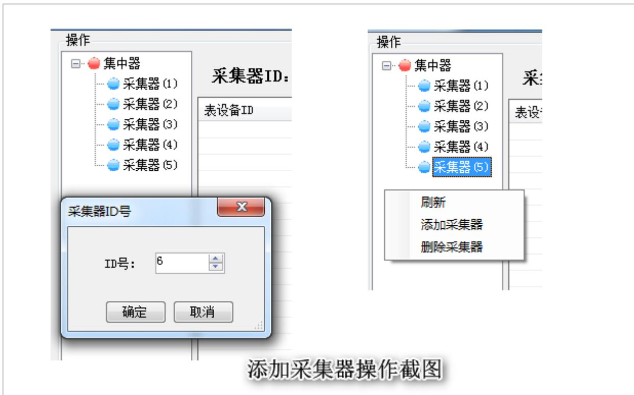
(3) 给采集器（JZX811A）路由器进行组网：自动组建网络或人工配置路径。单击集中器，弹出采集器组网对话框，根据现场采集器 ID 范围开始自动组网；或分别给每个采集器手工配置路径，并能通过软件读取采集器所走的路径。如下图所示：
