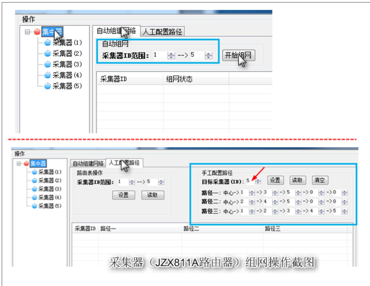
(4) 点击软件相应采集器，弹出表格，右键点击操作，把现场安装的所有表号人工添加到对应采集器（ID）下，由于 JZX811 节点终端模块不带 ID 号，所以抄表时软件直接对表号进行抄收。完成表号添加工作，此时可通过操作软件，JZX811B 中心协调器下发命令，对表进行远程读表度数、开阀、关阀等操作。表返回数据，并在抄表监控软件中体现抄表结果，如下图所示：
