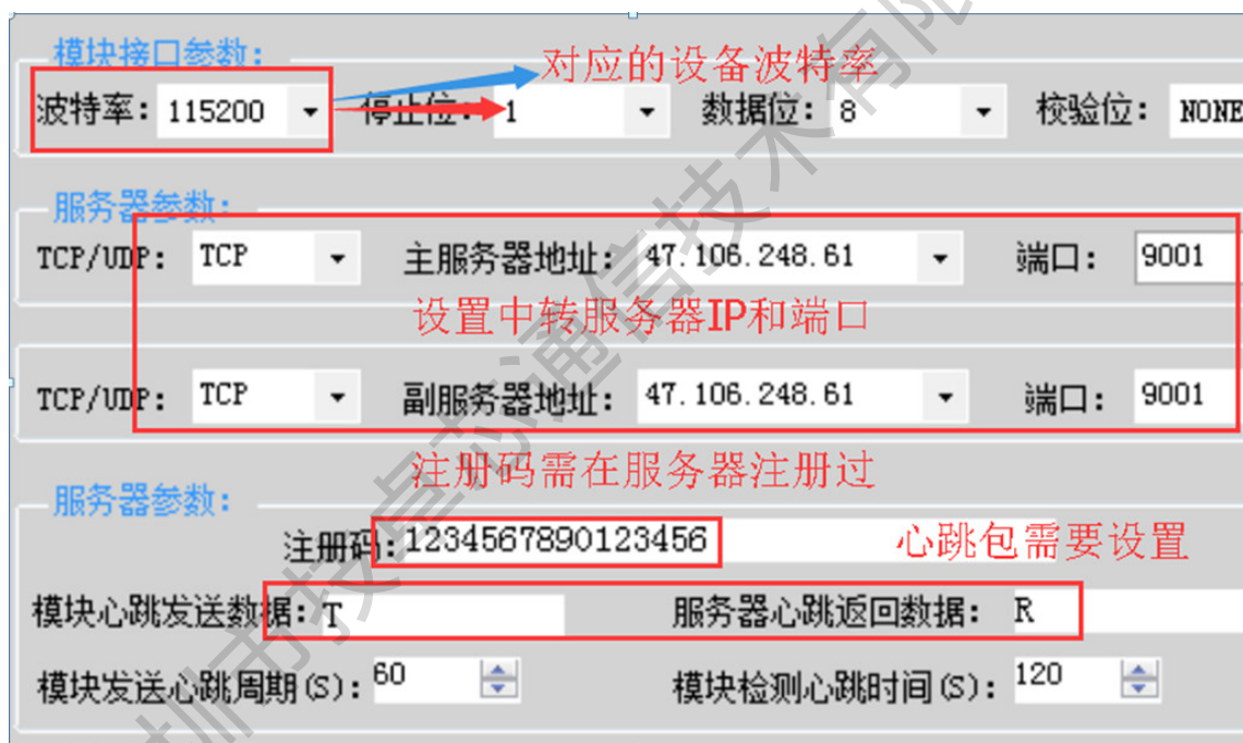
图七 DTU 转发功能主机配置
