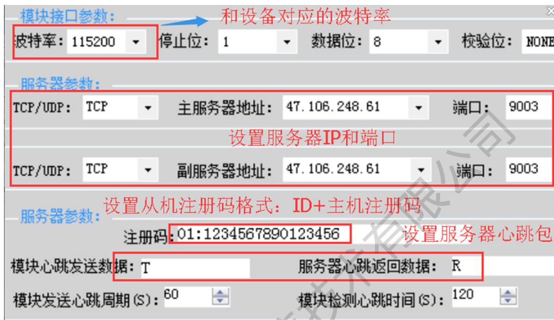
图八 DTU 转发功能从机配置
