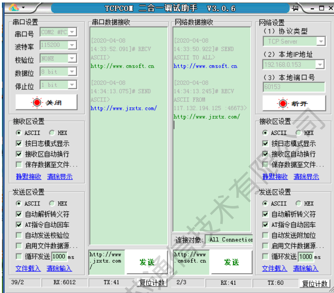
图四 DTU 与虚拟服务器透传测试
