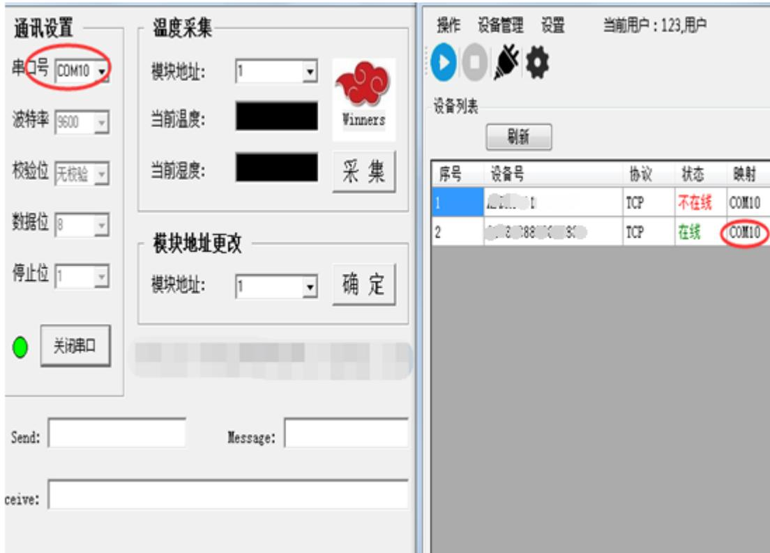
点击采集指令，返回数据（如不显示，采集软件需增加数据回复等待时间 1-2 秒），完成数据采集，DTU 客户端同步显示数据量，使用时可最小化后台运行。
