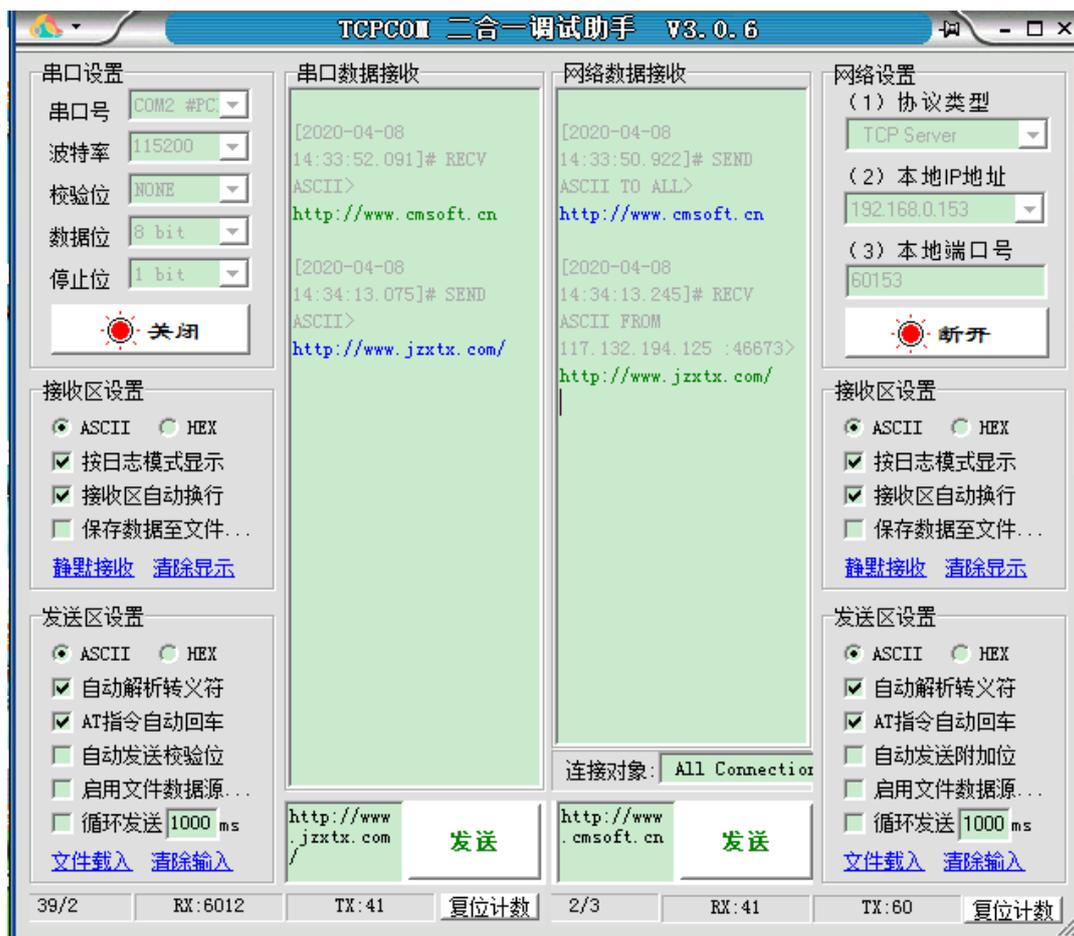
图五 DTU 与虚拟服务器透传测试
