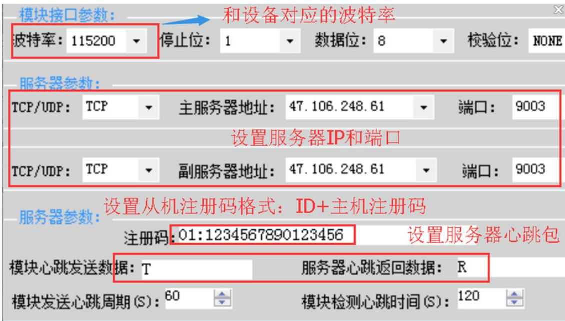
图九 DTU 转发功能从机配置
