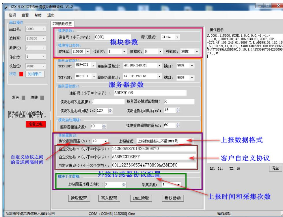
图十 传感器类上位机设置软件
