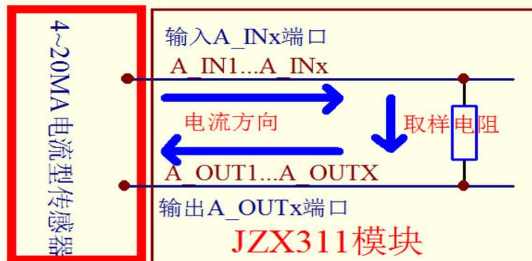
图五 4~20MA 电流采集接线参考示意图
